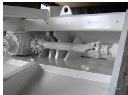
Kraftübertragung vom Mittelgetriebe zu den seitlichen Riemenantrieben über Kardanwellen Power transmission from central gearbox to side belt systems via cardan shafts
